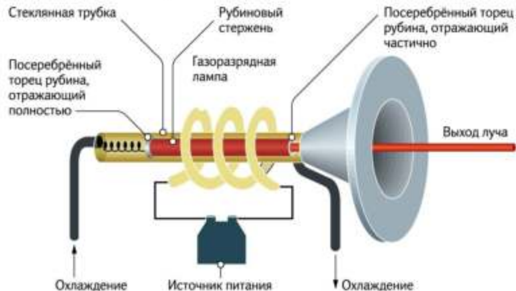
Схема первого лазера
